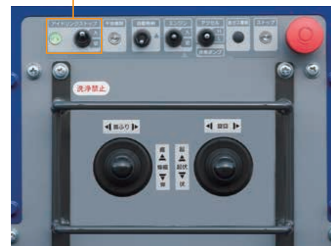
上部操作部：シンプルな操作機構を搭載(AT-100TG)
