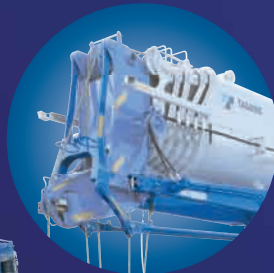
低位置において安全にテンションロッドの接続が完了。展開は空中で行うため限られたスペースで作業が可能です。
