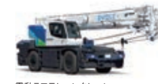
電動ラフテレーンクレーン GR-250N EVOLT
