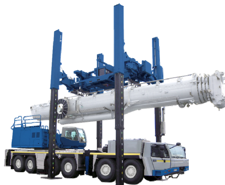
オールテレーンクレーンATF400Gのブーム着脱作業例
