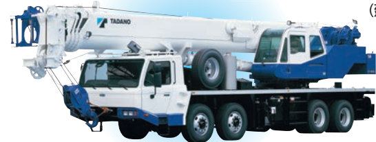
トラッククレーン (建設用クレーン)
