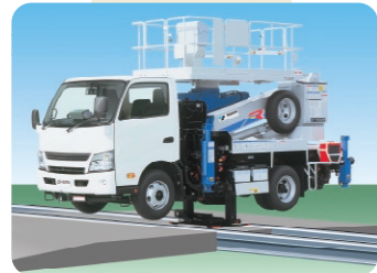
② 転車台で車両を浮かせます。
