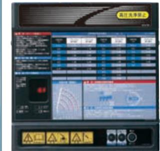
空車時定格総荷重表、作業半径揚程図、微速スイッチ、アクセルスイッチ、ホーンスイッチなどの便利機能を集約。一段と見やすく、使いやすくなった新デザインです。
