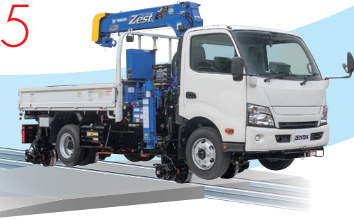
転車台を格納して、載線作業完了。
