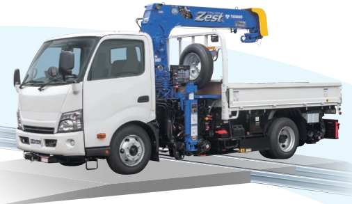
踏切から軌道内に入り、停車します。
