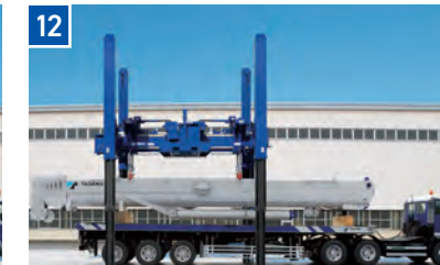
ジャッキ下げ操作およびセット装置下げ操作を行い、トレーラに載せる。
