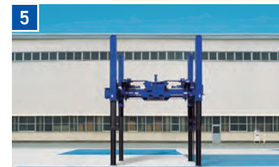
ジャッキを伸長し(ラジコンにて地上より操作)、リフター搬送用トラックを搬出。
