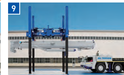
クレーンキャリアを搬出する。(クレーンキャリアは前後に通抜け可能です。)
