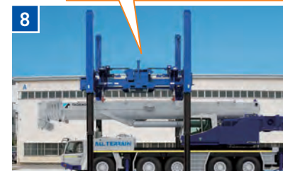
セット装置でブームを上げ、その後ジャッキを伸長させる。
