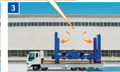
起こしたジャッキを外側へ張り出す。
