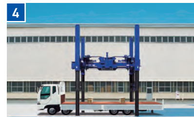
ジャッキを伸長し(ラジコンにて地上より操作)、リフター搬送用トラックを搬出。
