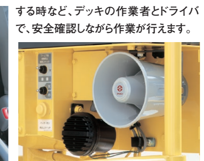
デッキ部インターホン
