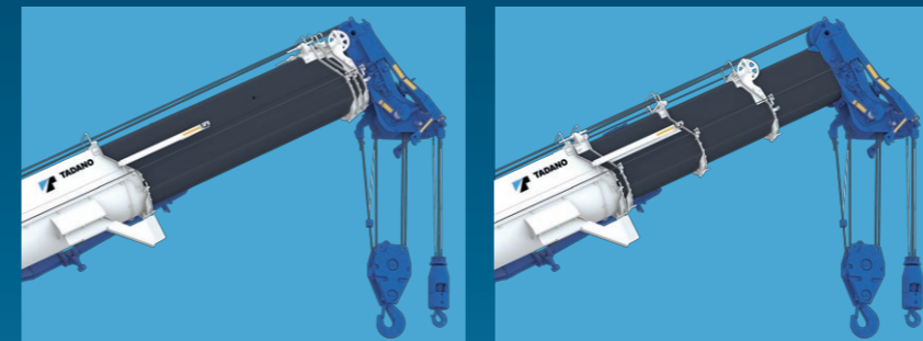
伸縮モード1 [2段目ブーム先伸長方式] 伸縮モード2 [3段目・4段目・トップブーム先伸長方式]
