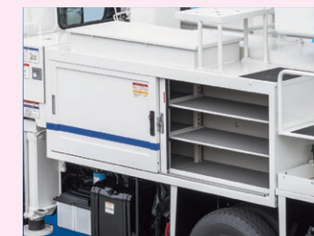
左側面：スライド式工具箱 (2段目以上の棚はオプション)
