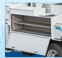
左側面:1段工具箱 可動棚(オプション)
