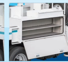
右側面:1段工具箱 可動棚(オプション)
