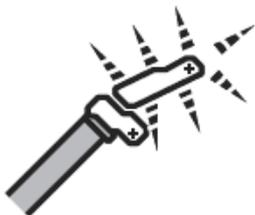
AML 表示パネル部のジブ状態シンボルが点滅時は「ジブセット作業」（点灯時は「ジブ作業」）
