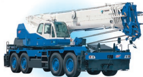
ラフテレーンクレーン (建設用クレーン)
