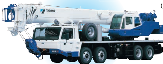
トラッククレーン (建設用クレーン)
