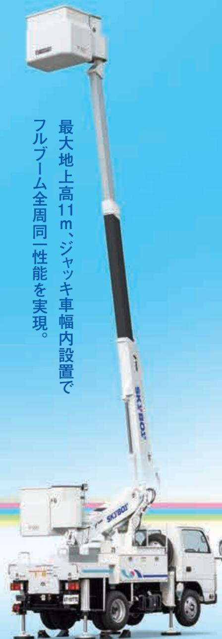
最大地上高11m、ジャッキ車幅内設置でフルブーム全周同一性能を実現。
