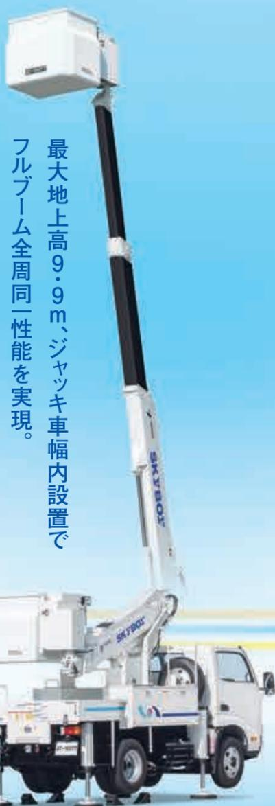
最大地上高9.9m、ジャッキ車幅内設置でフルブーム全周同一性能を実現。
