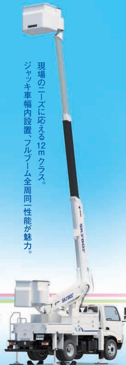
現場のニーズに応える12mクラス。ジャッキ車幅内設置、フルブーム全周同一性能が魅力。
