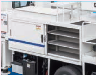
左側面：スライド式工具箱 (2段目以上の棚はオプション)
