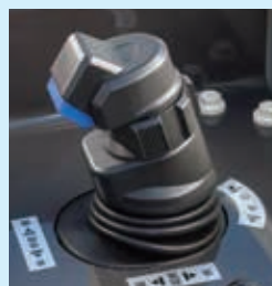
イネーブルスイッチ付 3軸ジョイスティックレバー (オプション)
