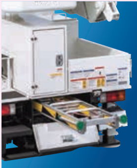
右側面：スライド式工具箱 (2段目以上の棚はオプション)
