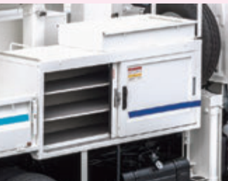
右側面：スライド式工具箱 (2段目以上の棚はオプション)
