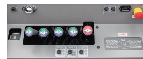
車両後端操作部
