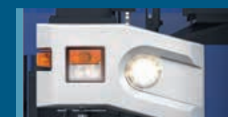
ブーム先端の左右に被視認性を高める高輝度のLEDライトを装備しています。
