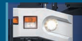
ブーム先端の左右に被視認性を高める高輝度のLEDライトを装備しています。
