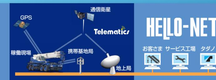
通信衛星や携帯端末などを用いてクレーンの稼働状況をリアルタイムで手軽に把握。故障の前兆をキャッチし、事前にメンテナンスする「ビフォアサービス」を可能にします。ラフテレーンクレーンを中心に標準搭載化を進め、国内約5,000台、海外約2,500台が稼働\*。現在はオールテレーンクレーンや高所作業車へも展開を開始しています。
