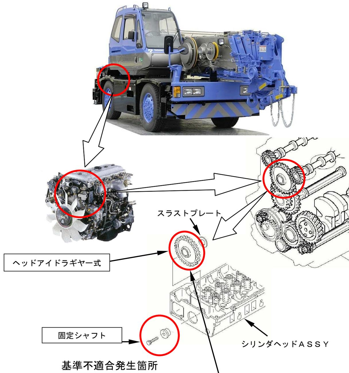
原動機のカムシャフト駆動用ヘッドアイドルギヤのブッシュの材質に不適切なものがあるため、ブッシュが早期に摩耗してブッシュと固定シャフトの間にガタが生じるものがある。そのため、そのまま使用を続けると、シャフトつば部の付け根に過大な応力が発生することがあり、つば部が破損してギヤが周辺部品と干渉し、異音が発生する。又はエンジンオイルが漏れ、最悪の場合、当該ギヤの噛み合いが外れて、エンジンが停止し再始動不能となるおそれがある。
