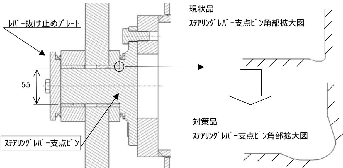
識別：レバー-抜け止めプレートに白色ペイントを塗布する。
