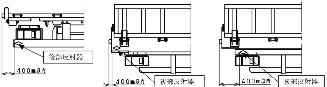
改善の内容 全車両、保安基準に適合する位置に後部反射器を追加する。
