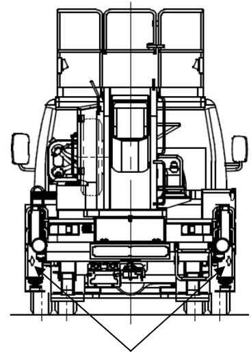
基準不適合箇所：後部反射器
