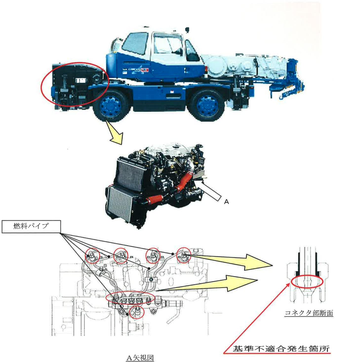
原動機において、燃料パイプ製造時に発生するコネクタ部内部のしわにばらつきがあり、また、パイプコネクタ部の締付トルクが低いものがある。このため、高い燃料圧力が加わることにより、当該しわ部を起点とした亀裂が発生し、燃料が漏れるおそれがある。
