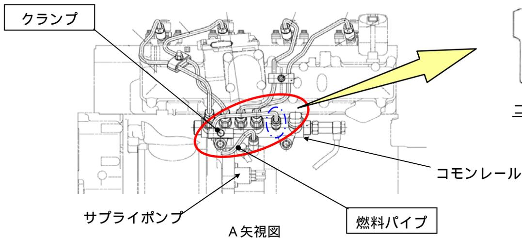
原動機において、サプライポンプとコモンレール間の燃料パイプを固定するクランプを付け忘れたものがある。そのため、エンジンの振動によりパイプに亀裂が発生し、燃料が漏れるおそれがある。
