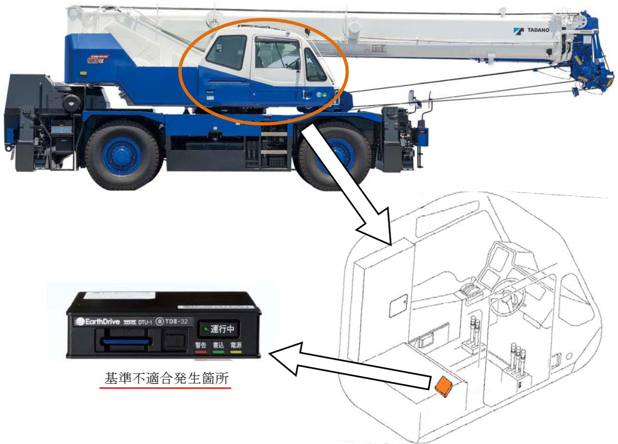
デジタル式運行記録計組み付け時の作業指示が不適切なため、初期設定をしていない。そのため、運行記録を記録することができない。
