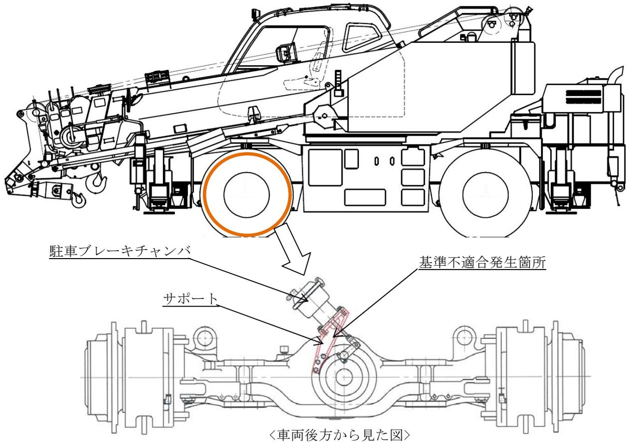
ホイールブレーンの制動装置において、駐車ブレーキチャンバのサポートの強度が不足しているため、サポートに亀裂が生じることがある。そのため、そのままの状態で使用を続けるとサポートが折損し、駐車ブレーキが効かなくなるおそれがある。
