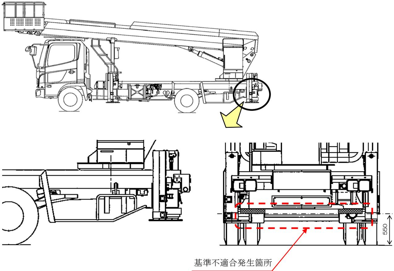
高所作業車の突入防止装置において、車両の設計が不適切なため、車両後面の構造物の下縁高さが550 mmを超え、保安基準に適合しない。
