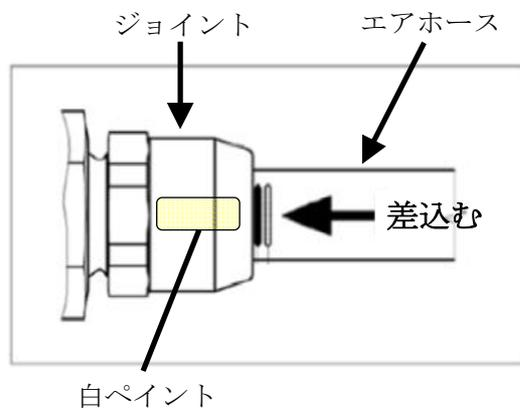
識別：点検した箇所のジョイントに白ペイントし、識別する。
