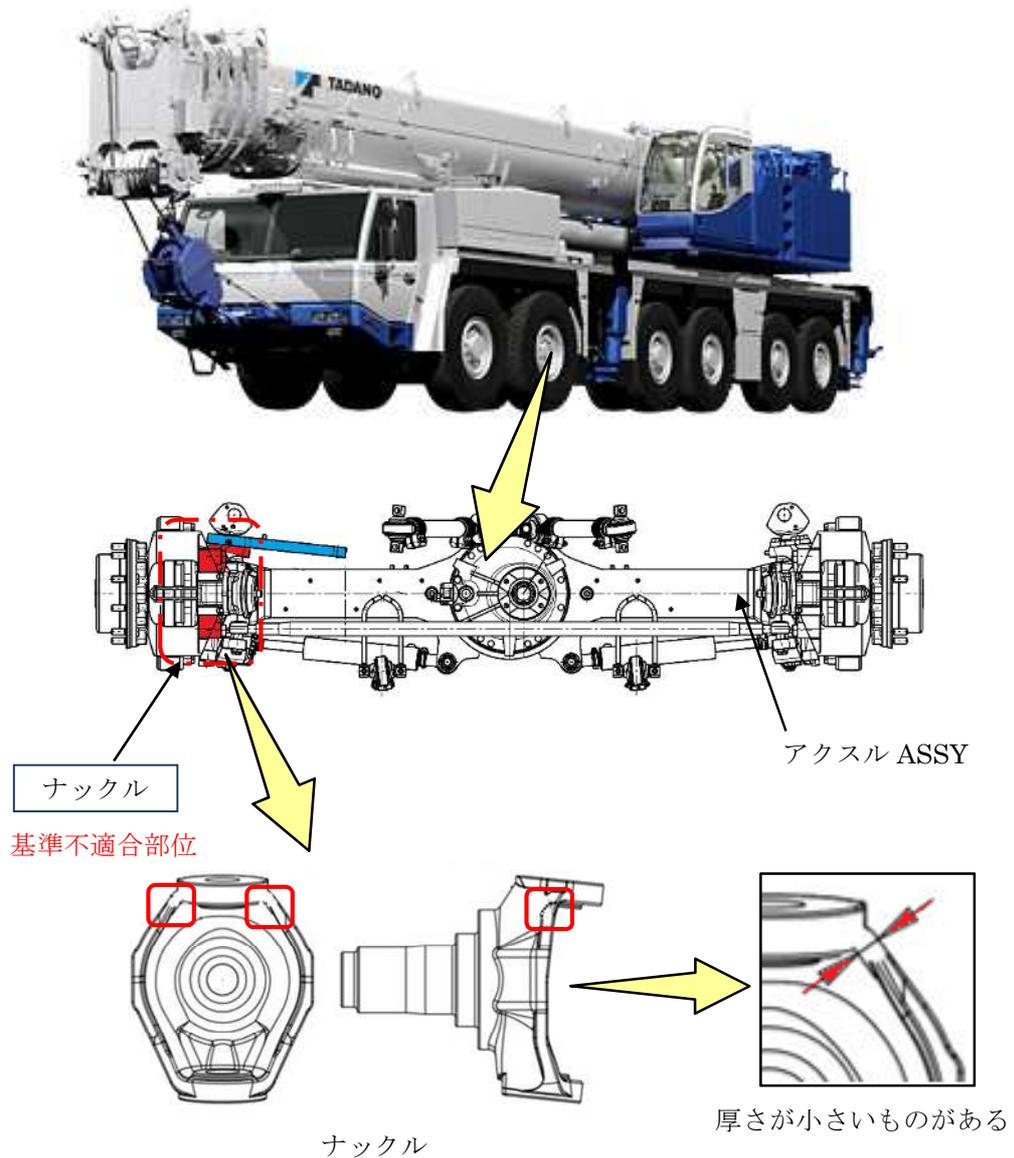
クレーン用台車のアクスルにおいて、設計図面指示が不適切なため、ナックルの厚さが不足しているものがある。そのため、長期間使用を続けると、ナックル上部に亀裂が発生し、最悪の場合、正常な操舵ができなくなるおそれがある。
