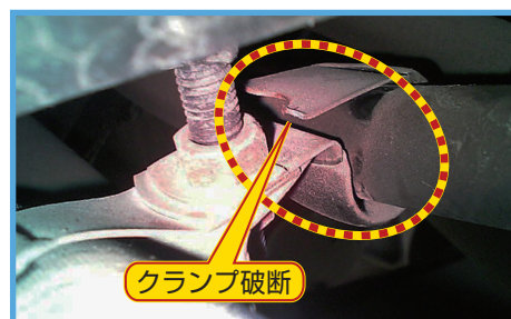
【ホースクランプの損傷例】
