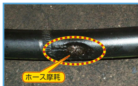
【油圧ホースの損傷例】
