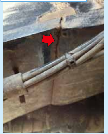
シャシーフレーム下板継ぎ部
