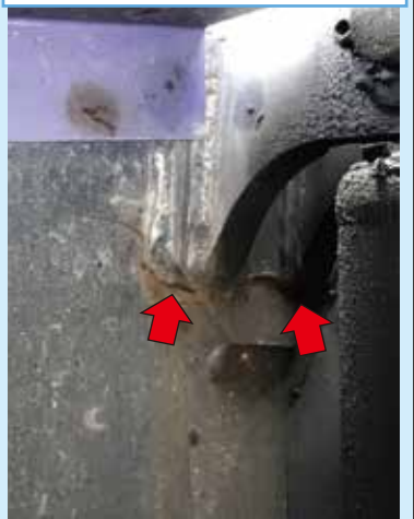
シャシーフレーム下板継ぎ部
