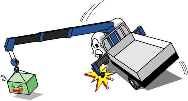
アウトリガを最小張出で設置し、荷台の荷物をつり上げ後方から側方へ旋回したところ転倒した。
