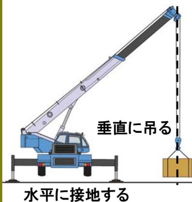
AML の実荷重表示は、つり荷を垂直につり上げた状態での荷重値を算出しています。
