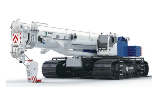
広大なアメリカで、泥濘地を含めたさまざまな環境で効率よく作業するように開発されました。クローラキャリヤの低重心の利点を活かし、高さに余裕のないトンネルやプラント、オイルタンクなどの設置現場で荷を吊ったまま走行し、その強さを発揮します。
