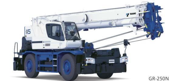
タダノの技術の粋を集めた主力製品。一つの運転席で走行とクレーン操作が行える自走式クレーンです。不整地や軟弱な地盤でも走行ができるほか、その小回り性を活かし、市街地や狭路などの現場でも活躍しています。海外では主に大規模プラントの建設・メンテナンスに使われています。
