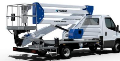
PM Oil & Steel製 トラック架装式高所作業車
