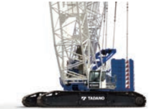
ラチスブーム式 クローラクレーン
