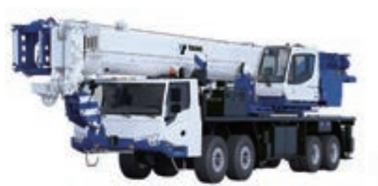
トラッククレーン
