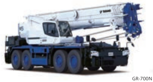
ラフテレーンクレーン
