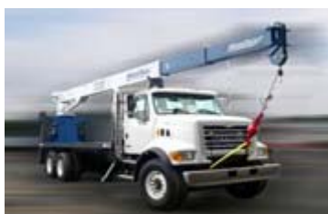
ブームトラック
